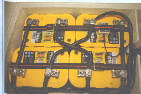
De 4 accu's voor de aandrijving van de elektromotor.
